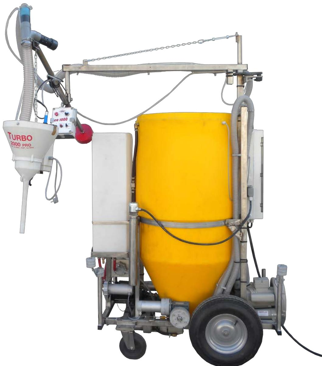
*La GME 560 est une gaveuse au maïs entier conçue pour les salles de gavage de 350 à 500 places (en simple bande).*
