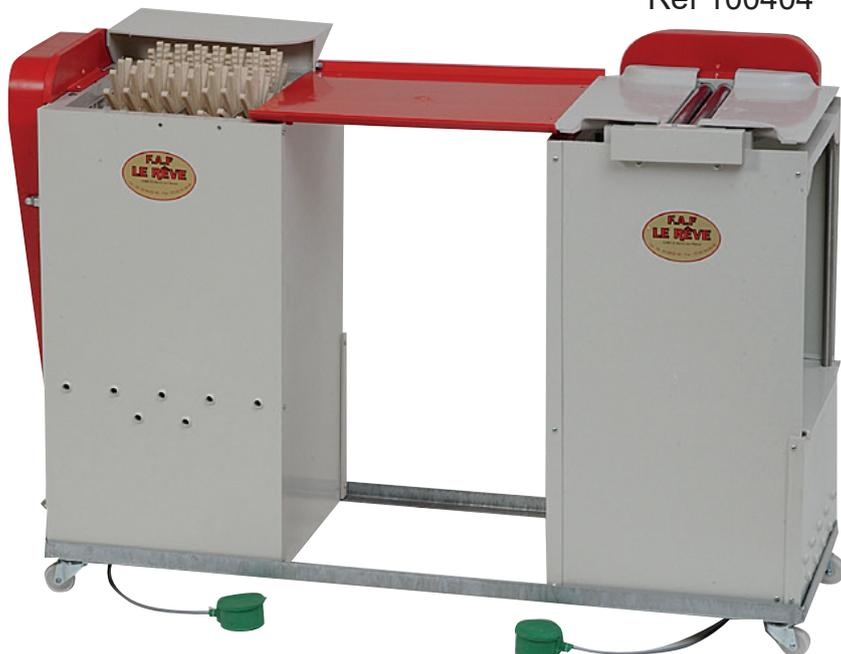
La plumeuse Le Rêve associe le bloc à rouleaux inox avec le bloc à doigts. Cette plumeuse est spécialisée pour les palmipèdes et notamment les canards gras. Les blocs sont posés sur un chariot à roulettes et reliés par une table. Cela permet de passer facilement la volaille d'un côté à l'autre sans la porter.
