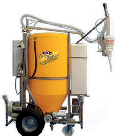
Gaveuse automatique pour gavage à la farine (possibilité de rajouter jusqu'à 30% de grain entier). La machine réalise le mélange eau/farine. Châssis inox. Cuve plastique. Réglage de la dose et de la vitesse d'injection. Avancement par joystick et auto-actif. Gavage en cages collectives et parc. Bras de gavage par devant ou par dessus. Option : batterie pour le déplacement. Gaveuse hydraulique, fonctionnement en 380V.
