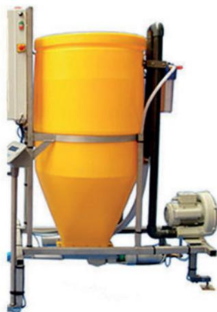
Gaveuse automatique pour gavage en parc. La gaveuse permet de donner un dose de maïs et d'eau à chaque canard. Variation de la vitesse. Choix de la dose de maïs et d'eau. Cuisson automatique (en option). La tête de gavage est suspendue à des rails au dessus des parcs.
