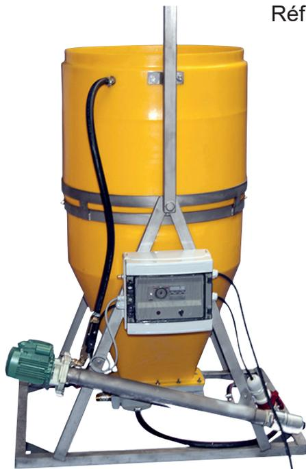
Ce cuiseur est équipé d'une cuve de 350 L en plastique de 11 mm d'épaisseur lui permettant une bonne conservation de la chaleur. Monté sur un châssis métallique, elle bascule sans effort pour faciliter la vidange. Une résistance de 6 kw assure la chauffe et le thermostat pilote la température. Vidange manuelle par le robinet au fond de la cuve. Cuve à fond incurvé pour faciliter l'écoulement de l'eau.
