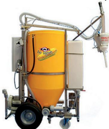
Gaveuse automatique pour gavage à la farine (possibilité de rajouter jusqu'à 30% de grain entier). La machine réalise le mélange eau/farine. Châssis inox. Cuve inox contenance 650L. Réglage de la dose et de la vitesse d'injection. Avancement par joystick et auto-actif. Gavage en cages collectives et parc. Bras de gavage par devant ou par dessus. Option : batterie pour le déplacement. Gaveuse hydraulique, fonctionnement en 380V.
