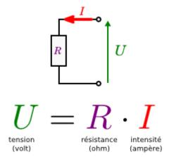
La tension est constante. L'intensité (I) délivrée par l'appareil va dépendre de la résistance (R) au niveau de la tête de l'animal.
