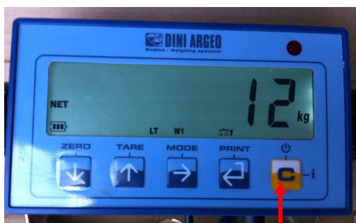
en appuyant sur la touche C, l'afficheur additionne les différents poids
