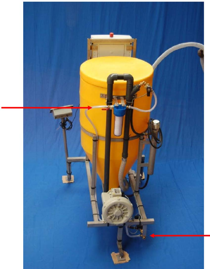
Fixer les tuyaux maïs et eau dans votre salle de gavage. Le tuyau d'eau arrive a la Turbo 2000 et ce branche sur l'électrovanne.
