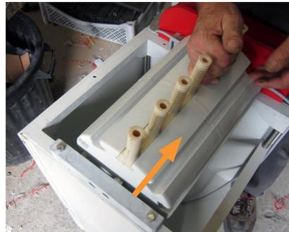
Pour la seconde barrette, inverser le sens d'insertion dans la rainure, le décalé en dernier. Et ainsi de suite en alternant les autres barrettes.
