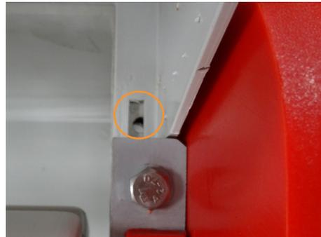
Ensuite, passer les 3 vis poelieres dans leurs trous. Fixer le déflecteur en maintenant la tête de la vis poelie avec un tournevis plat, puis en bloquant avec les écrous par en dessous.
